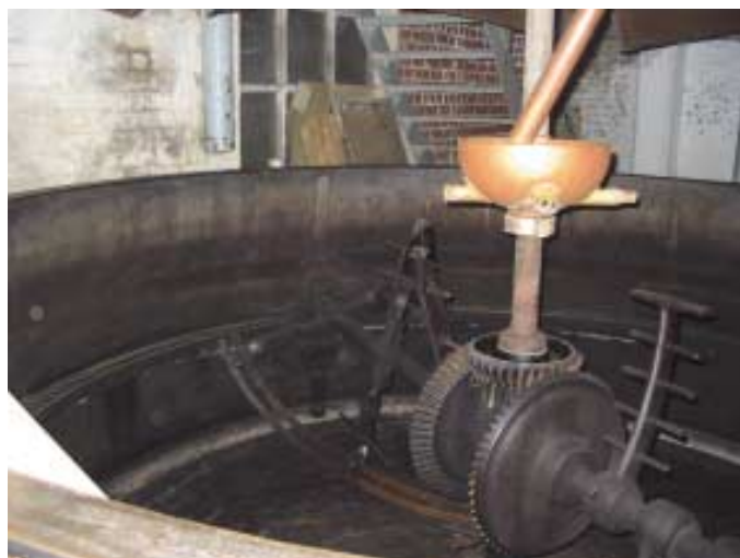
Het roerwerk in een vooroorlogse beslagkuip.
